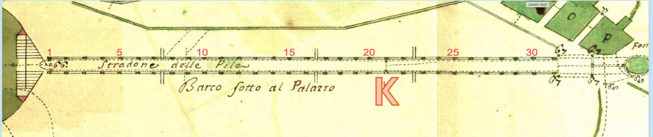
Buontalenti sistema in **K** due pozzetti trattenitori a galleggiante alimentati da una condotta pneumatica che consente di regolare la lunghezza degli zampilli, i getti sono prodotti con ugelli (di piombo?) saldati sopra dei tubi di piombo (fistule), la regolazione è affidata al sistema pneumatico e all'orientamento delle fistule, i trattenitori consentono di limitare il consumo idrico al minimo
