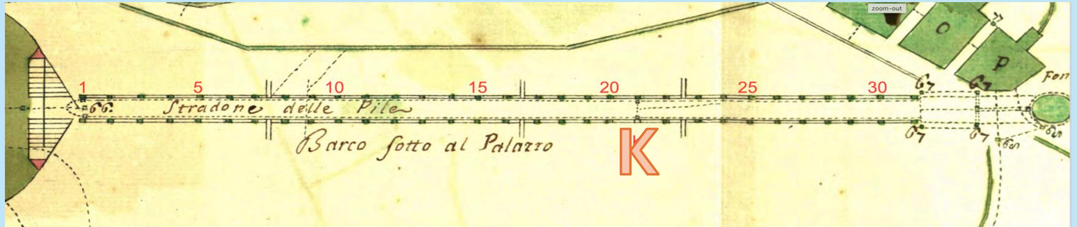
Buontalenti sa che una singola condotta di 6 cm di diametro non può alimentare l'intero sistema per cui opera suddividendo in tre condotte di cui due alimentano separatamente i primi duecento metri dei due lati, e il terzo alimenta gli ultimi cento metri di ambo i lati dopo il punto K, e deve fare sì che la pressione si mantenga costante
